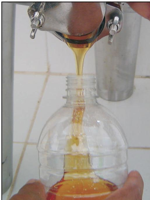
**Envase do mel de abelha sem ferrão após o processo de desumidificação e decantação**
